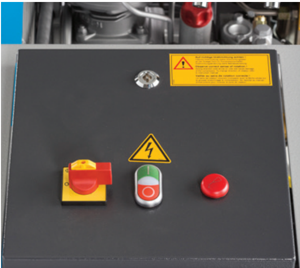
Commande du compresseur du modèle MARINER, avec interrupteur principal, dispositif de mise en et hors service et voyant de signalisation pour le contrôle du niveau d'huile / du sens de rotation
